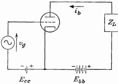
FIG. 6-18. A triode circuit.
